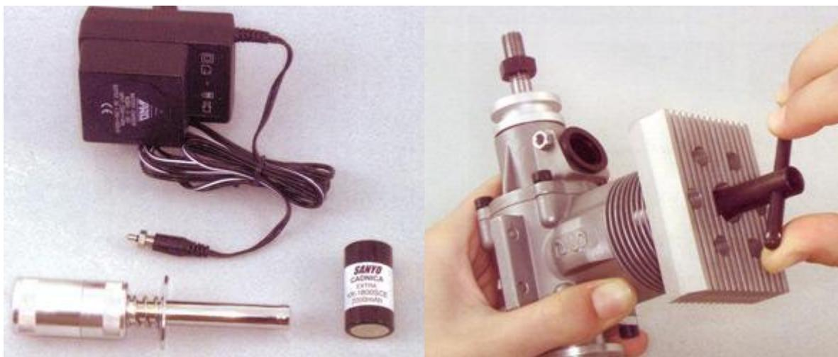
1) Equipement complet pour l'alimentation de la bougie : chargeur (en haut), feeder avec sa pince et élément Ni-Cad.
